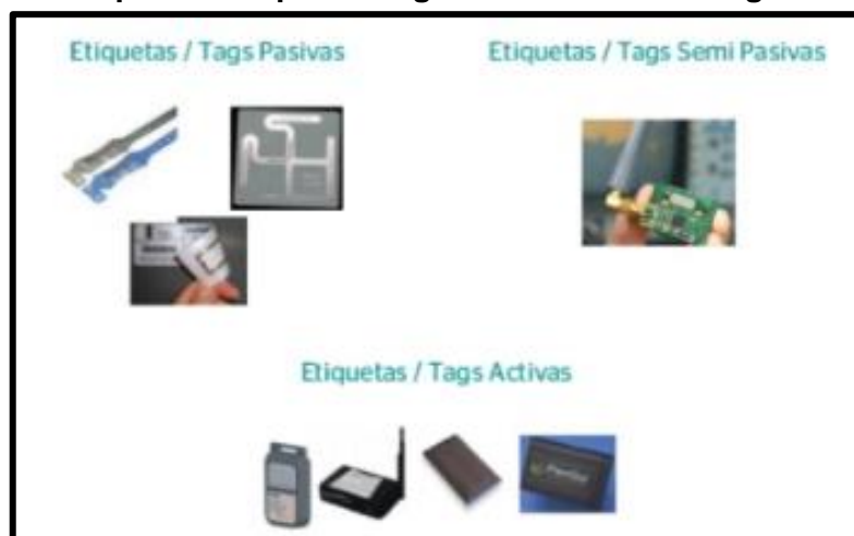
Gráfico 2.3 Tipos de etiquetas según su fuente de energía
