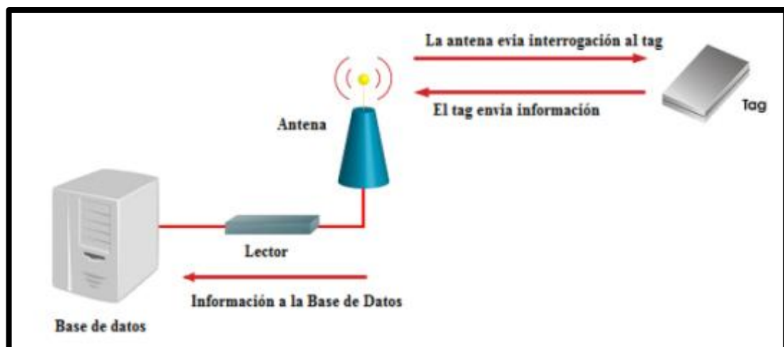
Gráfico 2.1 Funcionamiento de un Sistema RFID
