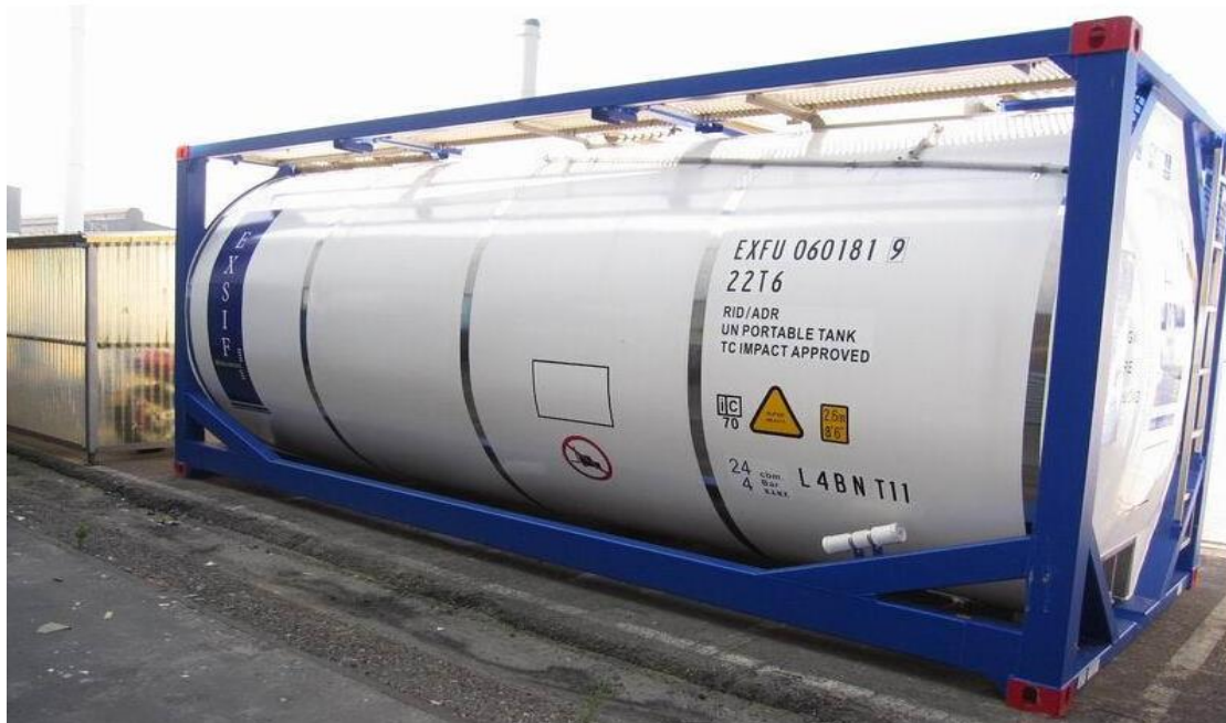
Figura 19. Tanque contenedor 4000 litros para líquidos al granel.
