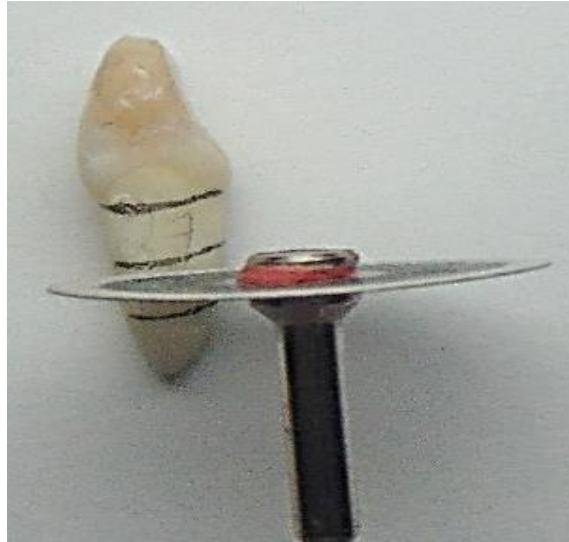
Ilustración 3 Corte de la raíz con disco de diamante
