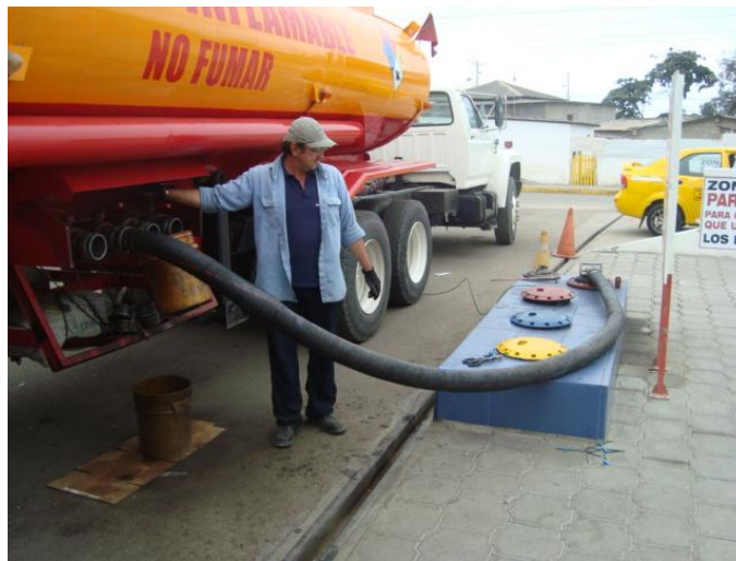
FIGURA 4 DESCARGA DE COMBUSTIBLE
