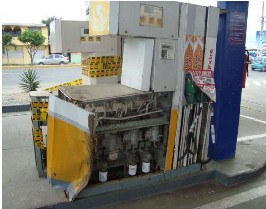
FIGURA 10 SURTIDOR AVERIADO POR CHOQUE DE UN VEHICULO
