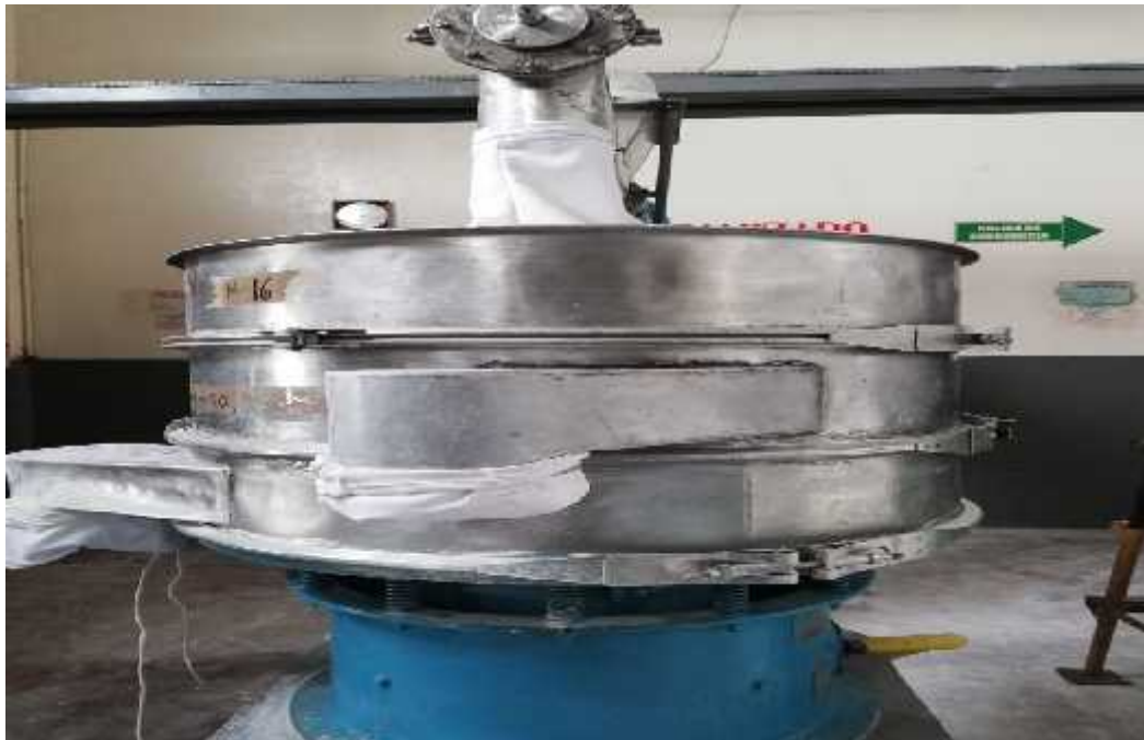
Figura 12. Tamizador N-209. Información adaptada de Dan Química C.A. Elaborado por el autor.
