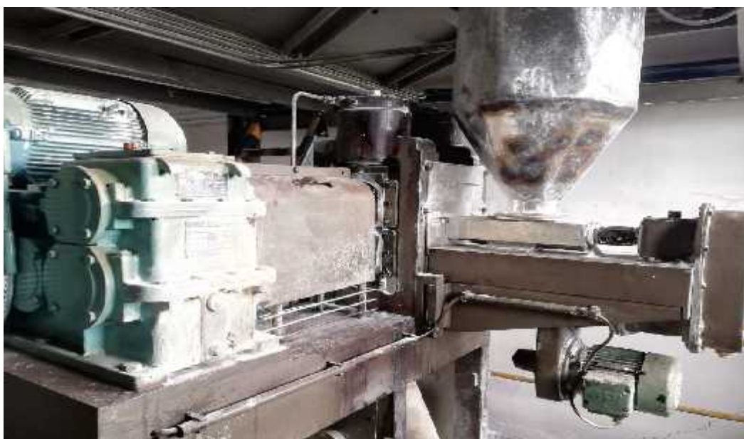
Figura 13. Compactador Alexander Work tipo WP 150v. Información adaptada de Dan Química C.A. Elaborado por el autor.
