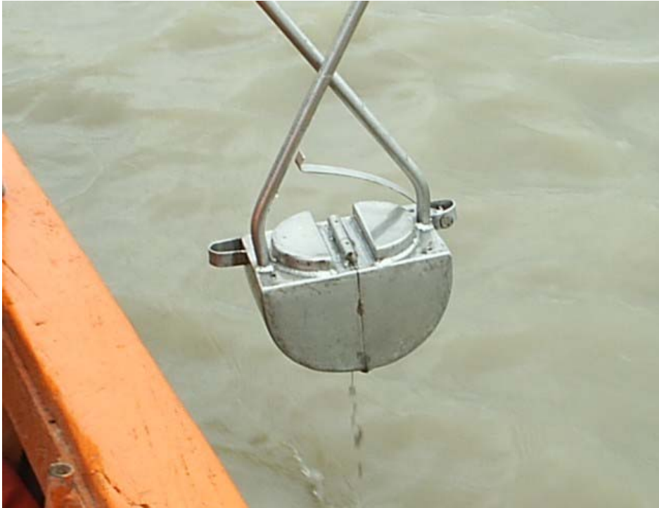
Fotografía 7. Recolección de muestra de sedimento con la draga Van Veen.
