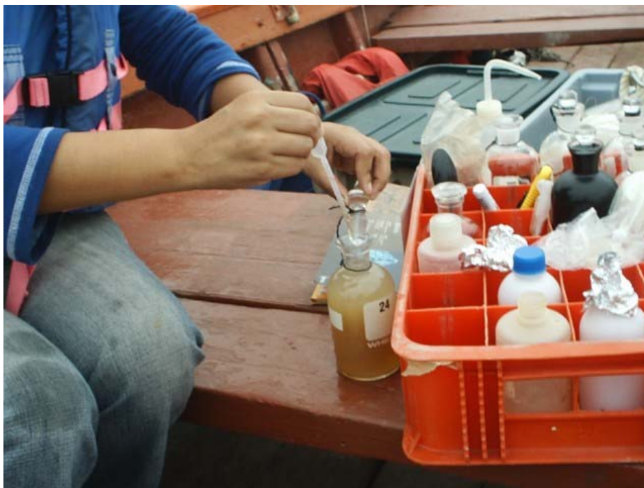
Fotografía 4: Adición de los reactivos para la determinación de oxígeno disuelto (método de Winkler).
