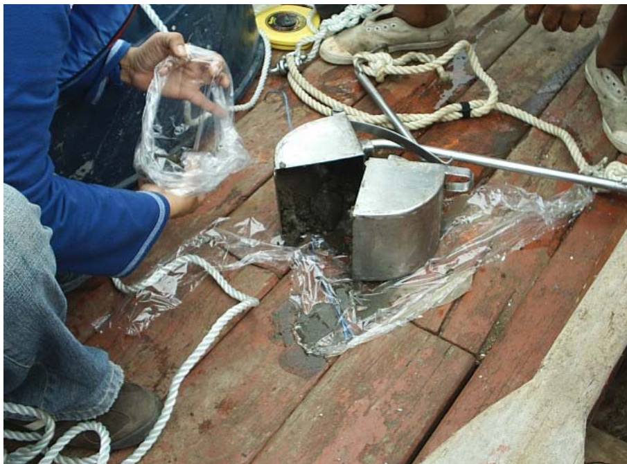
Fotografía 8: Recolección de muestra de sedimento con la draga Van Veen.
