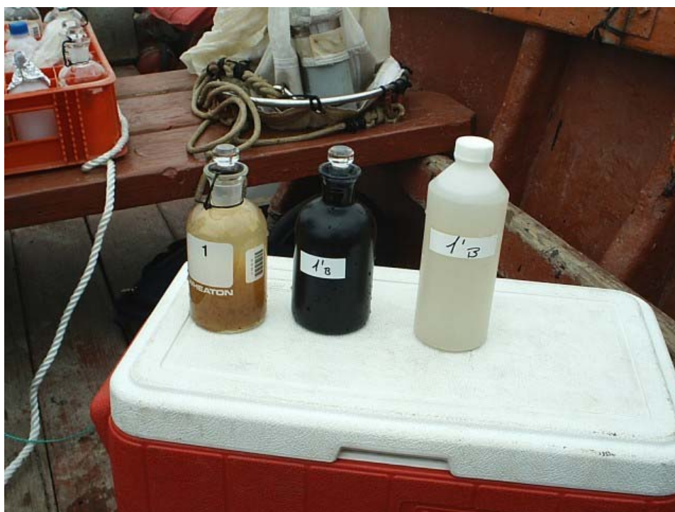
Fotografía 6: Muestras de agua para la determinación de los diferentes parámetros químicos (OD, DBO5, aceites y grasas).
