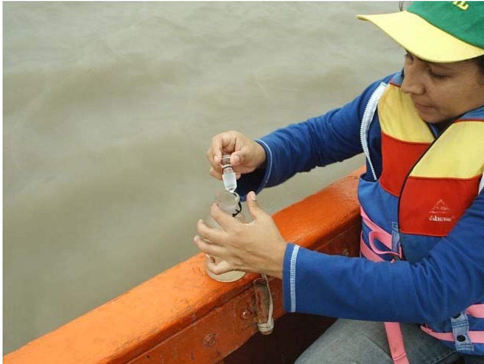
Fotografía 3: Recolección de la muestras para la determinación de oxígeno disuelto.
