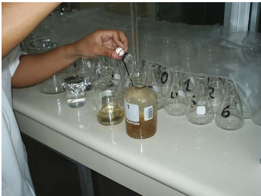
Fotografía 9: Adición de ácido sulfúrico para la disolución del precipitado y liberación del yodo.
