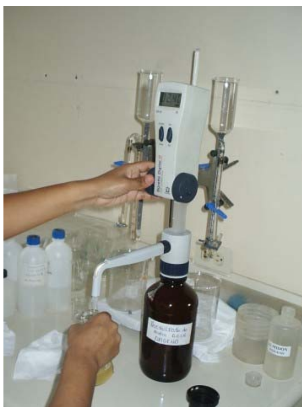
Fotografía 10: Titulación de la muestra con solución valorada de tiosulfato de sodio.
