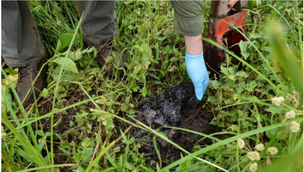
*Ilustración 17: Perforación de suelo para verificar contaminación en cercanías al pozo Shushufindi 34*
