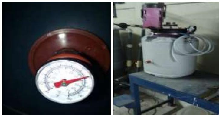
Figura 25. a) Termómetro en el biodigestor b) Chaleco térmico
