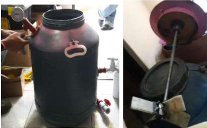
Fotografía 1. Tanque y agitador empleados en el biodigestor con agitación
