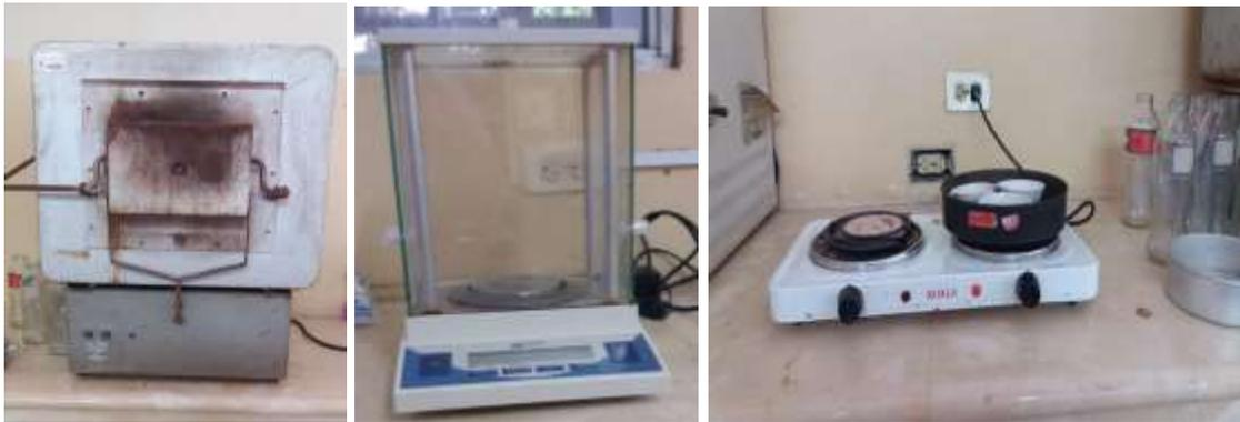
Figura 26. Equipos a) Mufla b) Balanza analítica c) Parilla eléctrica utilizados los análisis de caracterización de la mezcla inicial y productos
