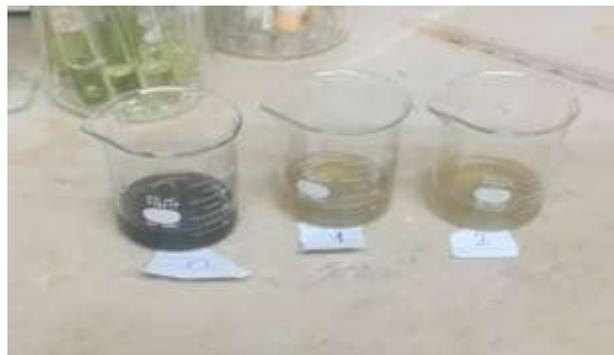
Figura 29. Preparación de las muestras iniciales del biodigestor para determinar el contenido de sólidos totales disueltos
