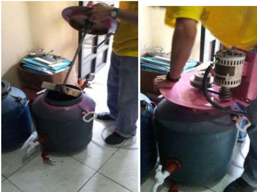
Fotografía 2. Acoplamiento del agitador al biodigestor
