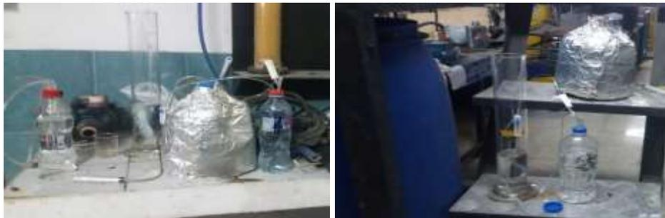
Fotografía 10. Vista frontal de los biodigestores sin agitación y su respectivo sistema de desplazamiento volumétrico
