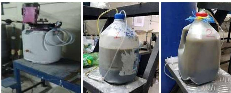
Fotografía 4. Biodigestores con agitación y biodigestores sin agitación discontinuos sin alimentación
