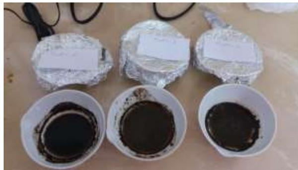
Figura 27. Muestras iniciales, luego del baño maría para determinar el contenido de ST
