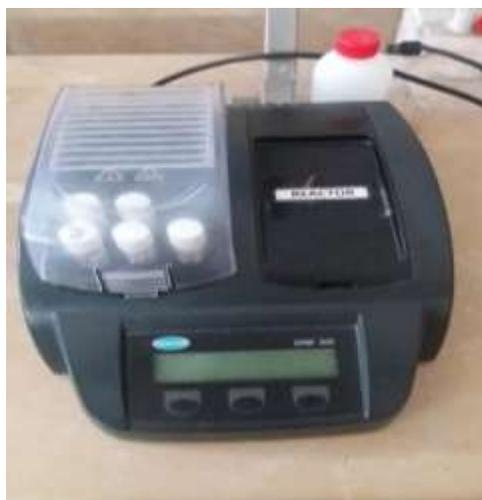
Figura 30. Reactor HACH y muestras para calentar a 150°C
