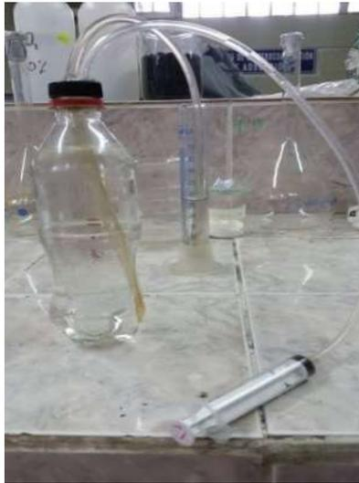
Figura 31. Envases de recolección y determinación de la composición del biogás
