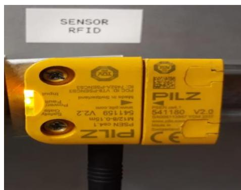
**Fuente:** Funcionamiento del sensor RFID
