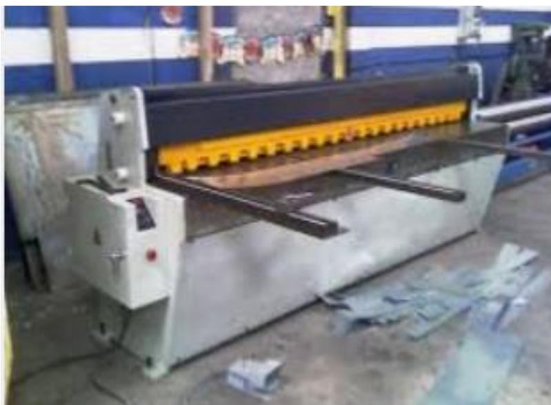
**Figura 11.** Corte con Cizalla. Información adaptada de Web Maquinaria Industriales. Elaborado por el autor.
