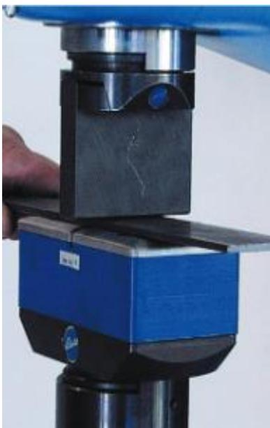
**Figura 10.** Enderezado. Información adaptada de ECKOL. Elaborado por el autor.
