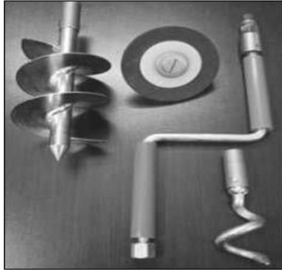
**Ilustración 15.** Accesorios de limpieza, que conectan a varillas de acción mecánica.
