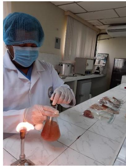
*Ilustración 23 Homogenización de la muestra.*
