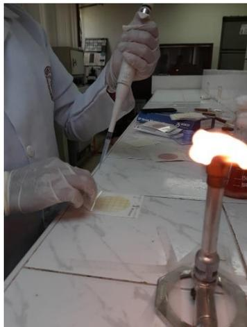
*Ilustración 33 Pipeta semi-Automática.*
