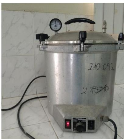
*Ilustración 6 Autoclave*
