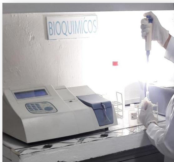
**Fotografía N° 7:** Toma del estándar para la lectura en el equipo Analizador semiautomático de Marca Erba Mannheim, Modelo Chem5 v3
