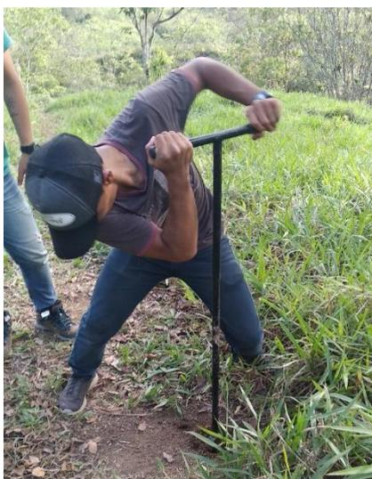
Fig. 18: Muestreo del Perfil 9 con auger. (Villacis, K., 2020).
