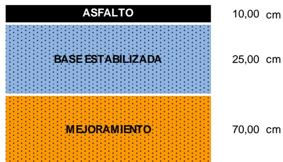
*Figura 19.* Nueva Estructura de Pavimento.
