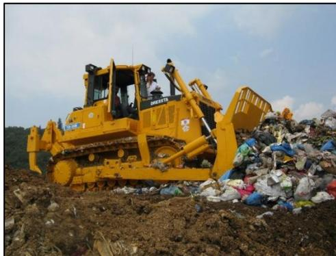
**Ilustración 6:** Bulldozer compactador de Residuos Sólidos.
