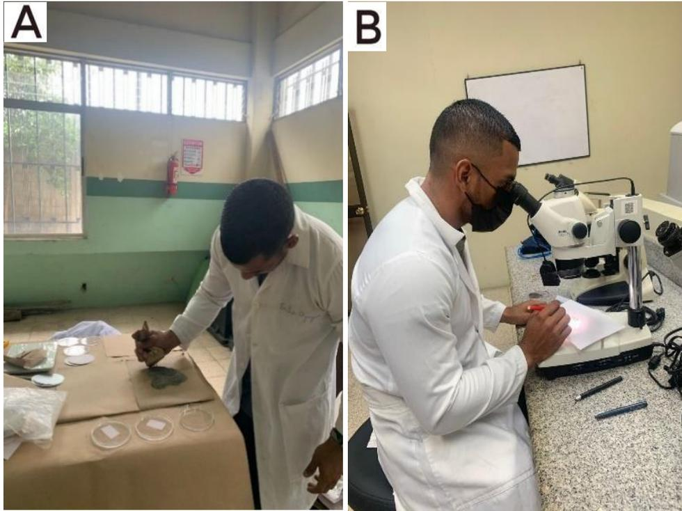
Figura 15. A: Uso de imán para separación por fracciones magnéticas Laboratorio Rufilli (Facultad de Ciencias Matemáticas, UG) B: Identificación de minerales bajo lupa binocular Laboratorio de Petrografía (Facultad de Ciencias Naturales, UG)
