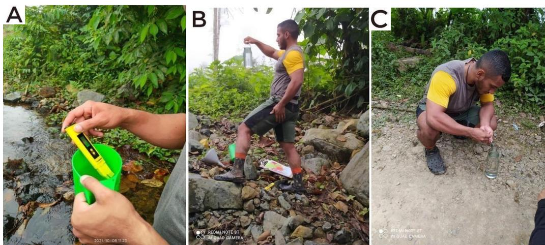
Figura 10. A: Medición de pH B: Embotellado C: Acidificación
