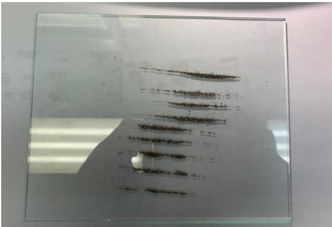
Figura 16. Base de vidrio utilizada para la separación de los granos e identificación mineral bajo lupa binocular <sup>35</sup>
