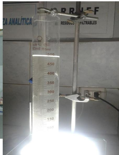
El promedio del tiempo de sedimentación en los ensayos realizados en laboratorio es de 2.08 hr. relacionando esta cantidad con el tiempo de retención 3.7 hr. calculado en los dos tanques sedimentadores actuales se tiene que cubren con la demanda de la planta, además cumple con el tiempo de retención mínimo de acuerdo a la norma INEN 005-9-1 (1992).
