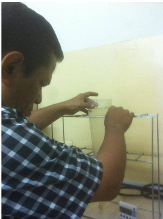
Anexo N° 19 Foto N° 14 Ensayo de sedimentación de sólidos suspendidos
