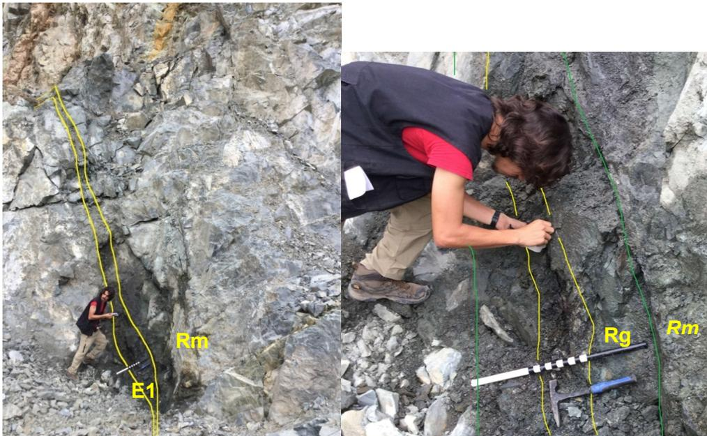
**Figura 3.1.5.-** a) Afloramiento de muestra M9-Rm-E1. Estructura de dirección  $184^{\circ}/60^{\circ}$  (E1), de hasta 15 m de longitud (líneas amarillas), b) roca encajante de la estructura (Rg líneas verdes) y roca matriz (Rm)
