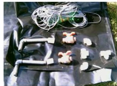
Accesorios de conexión tubería biogás
