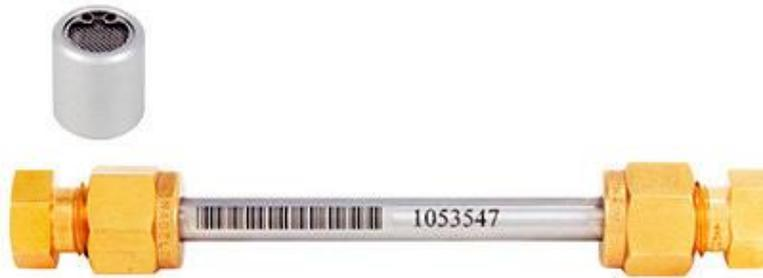
**Figura 45.** Tubos de desorción térmica. Información tomada de REDMSA. Elaborado por el autor.
