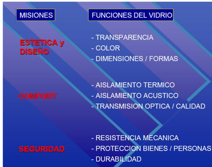
Figura 1.2.- Exigencias para el vidrio plano como material de construcción.
