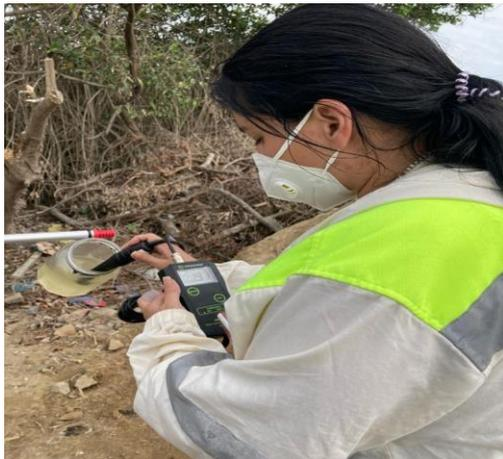
**Figura 23.** Medición de oxígeno disuelto.
