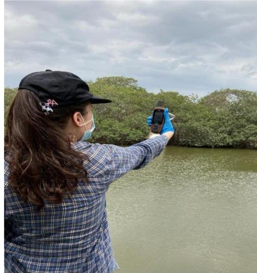
**Figura 20.** Obtención de coordenadas.
