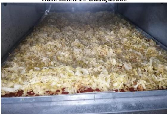
*Ilustración 12 Deshidratación en horno*
