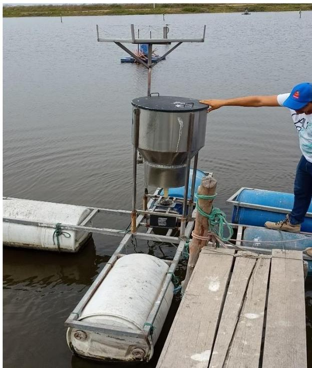
**Figura 14.** Alimentador Automático. Información tomada de Agrosecom S.A. Elaborado por el autor.
