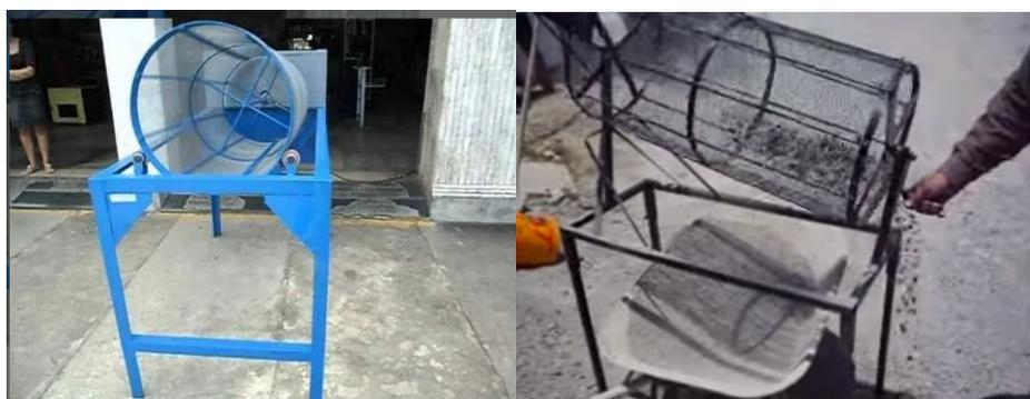
*Figura 25. Tamizadora manual cilíndrica para cribar abono orgánico. Información tomada de la web.*
