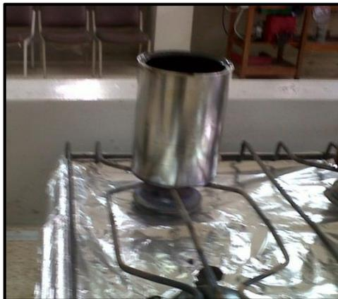
**Ilustración 30:** Calentamiento del cemento asfáltico
