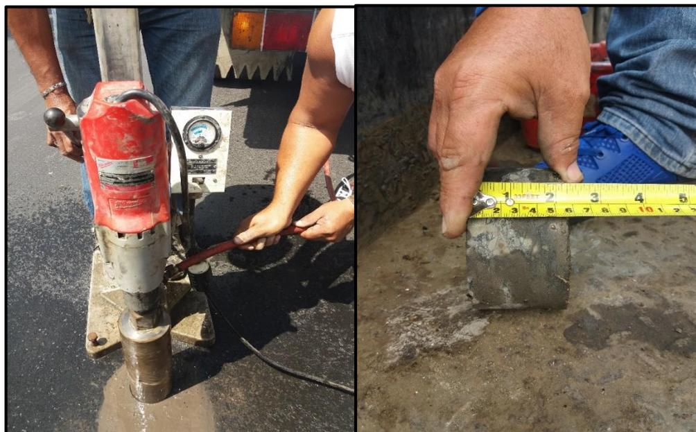
**Ilustración 9:** Núcleos de asfalto
