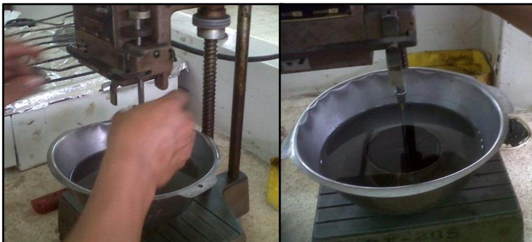
**Ilustración 13:** Penetración de la muestra
