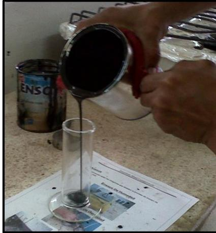
**Ilustración 32:** Colocación del cemento asfalto
