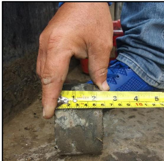
**Ilustración 82:** medición de núcleos de asfalto
