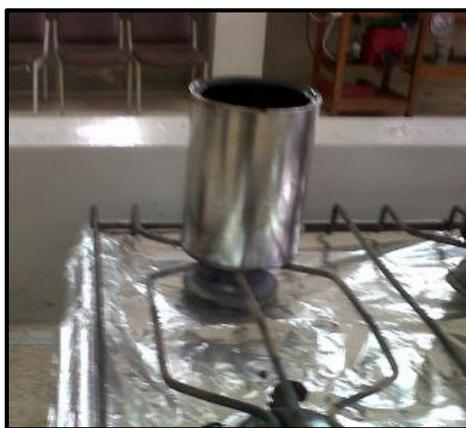
**Ilustración 23:** Calentamiento del cemento asfáltico
