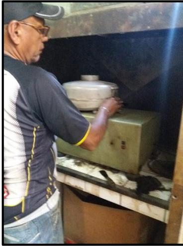
**Ilustración 45:** Colocación de tapa del extractor
