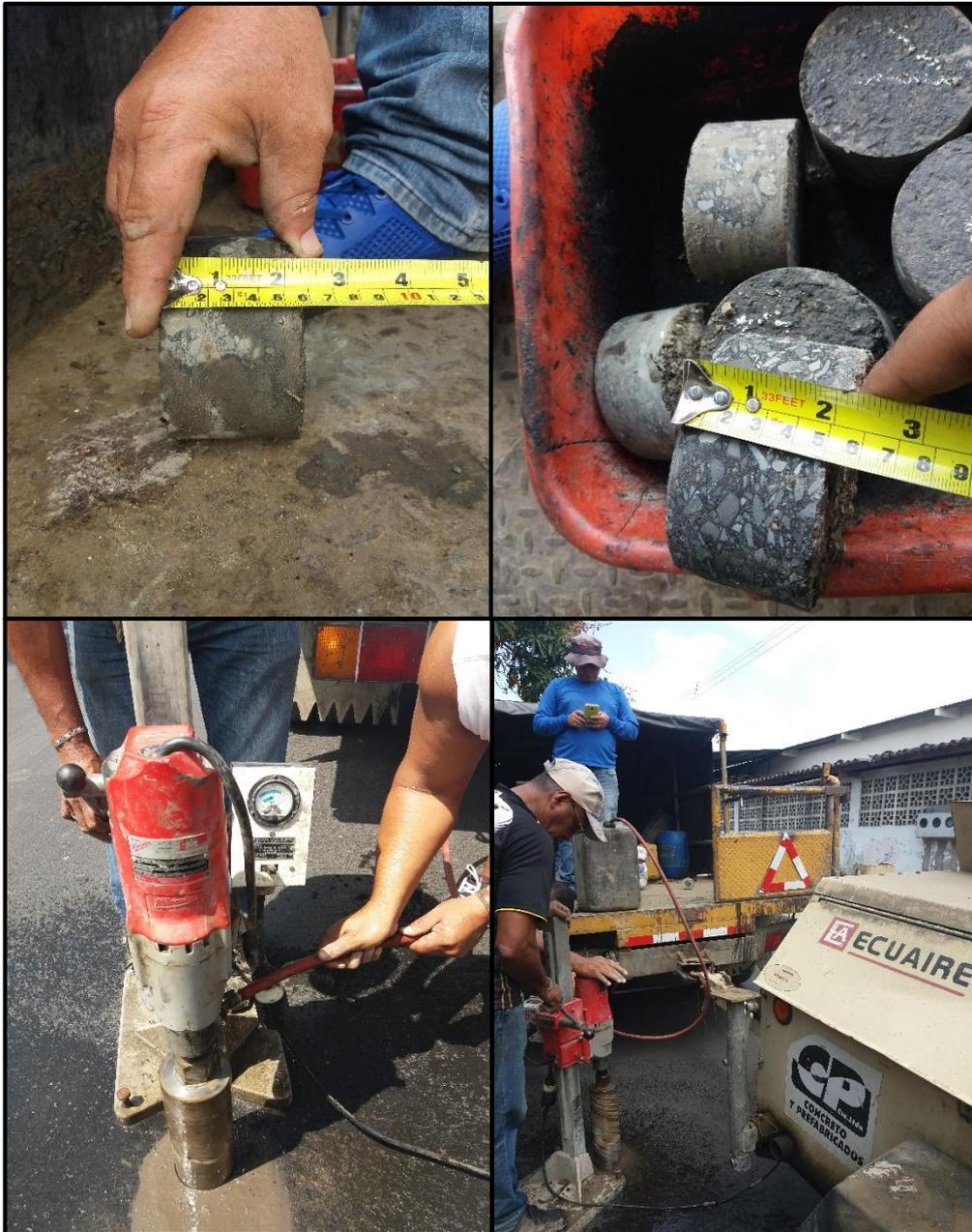
Ilustración 75: Núcleos de asfalto
