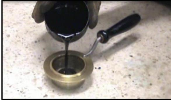
**Ilustración 35:** Colocación del cemento asfáltico
