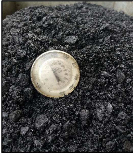
**Ilustración 6:** Temperatura del asfalto
