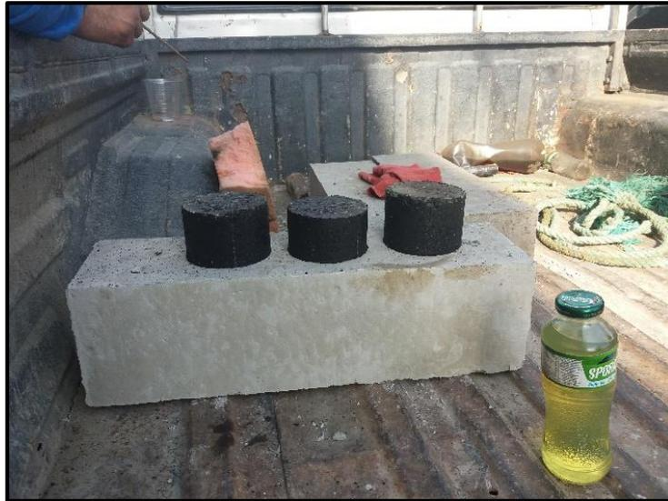
**Ilustración 60:** Briquetas de Asfalto
