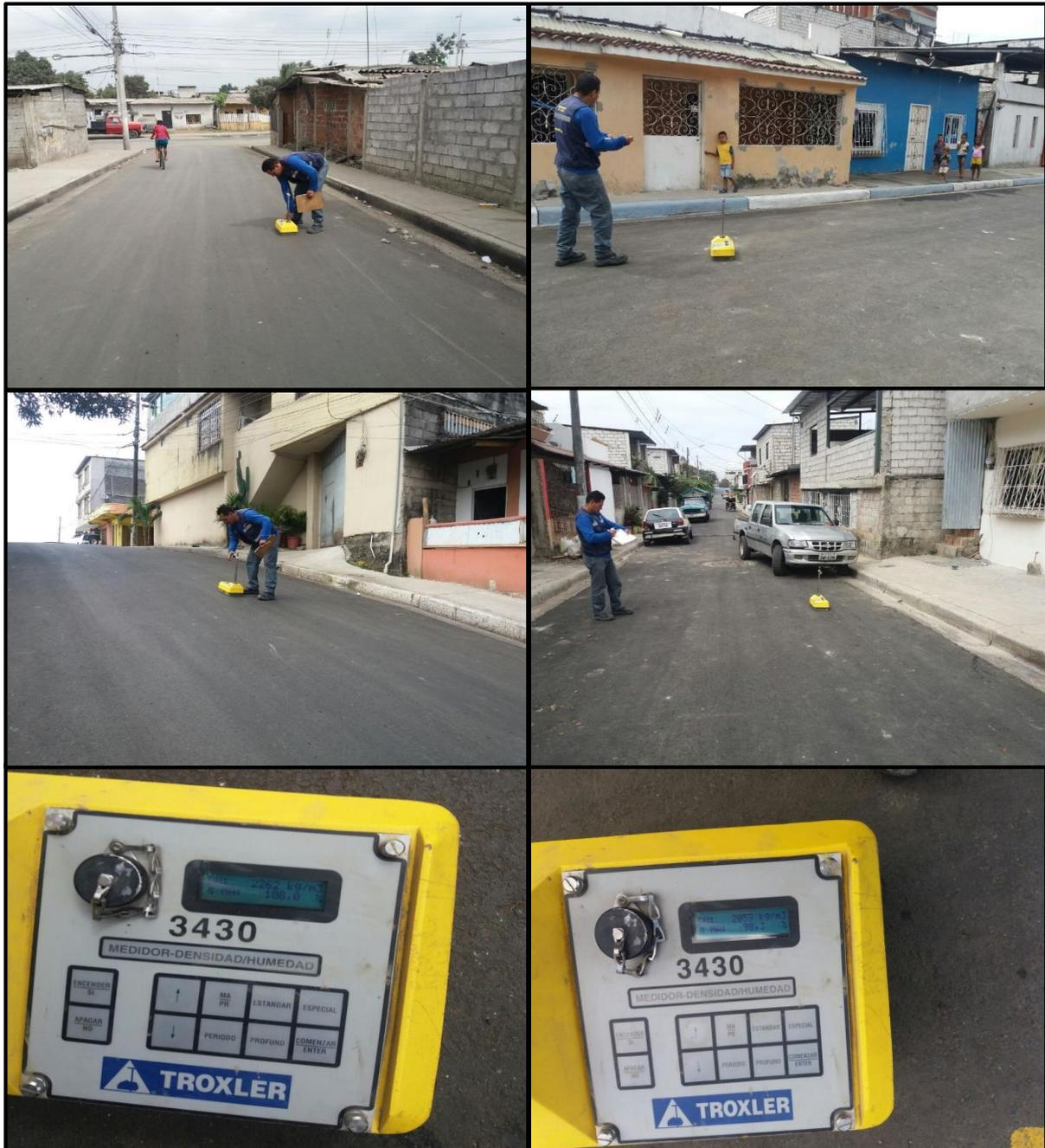
**Ilustración 74:** Densidad de Campo al asfalto
