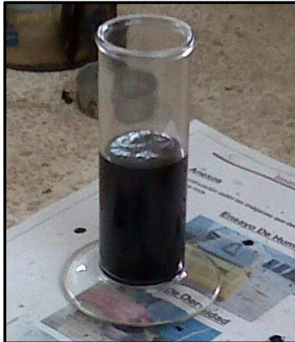
**Ilustración 33:** Picnómetro y cemento asfáltico
