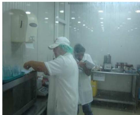
Se procede a sellar las bolsas en las campanas de vacío, operación que consiste en eliminar el oxígeno de la bolsa y sellarla térmicamente para asegurar la calidad del producto envasado durante el tiempo máximo legalmente establecido. A continuación se somete las bolsas al retractilado haciéndolas pasar por un baño con agua caliente incrementando la protección al eliminar las arrugas que produce en la fase de vacío.
