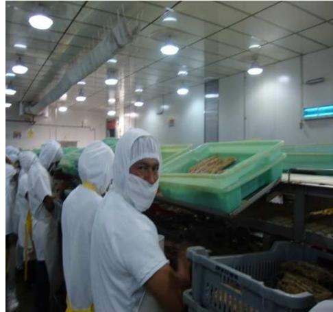
Entero ó cortado pasa por un túnel de lavado para eliminar, en lo posible, restos de suciedad y sangre. Los cestos de pescado se estiban en base formando el bastidor que está listo para introducirlo al cocedor.
