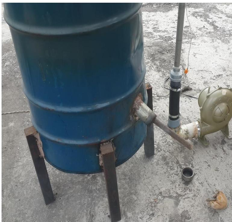
**Introducción de la antorcha para el encendido del equipo**
