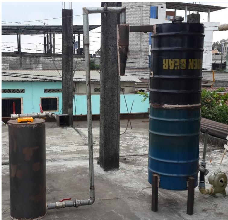
**Gasificador con sus sensores de temperatura y ventilador.**
