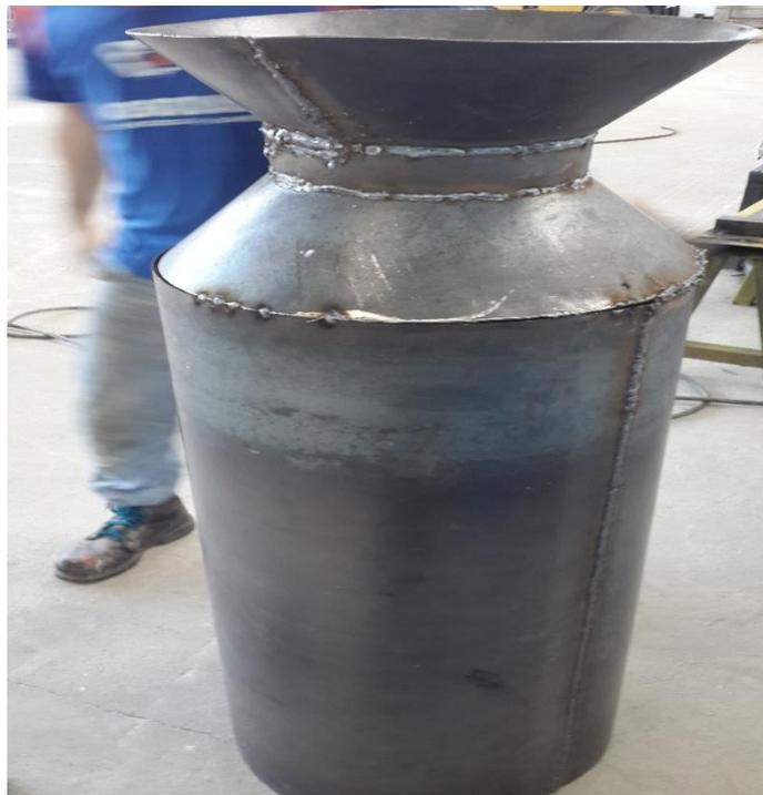
**Ensamblaje entre el tanque y la garganta**
