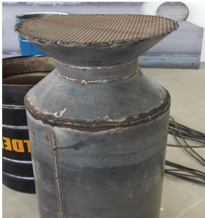
**Ensamblaje de la malla a la parte inferior de la garganta**
