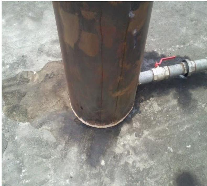
**Aceites y alquitranes condensados debido a fugas del gas #2**
