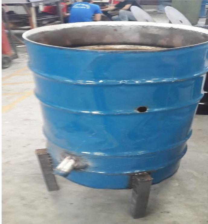
**Carcasa del gasificador con su respectiva patas y tuberías.**
