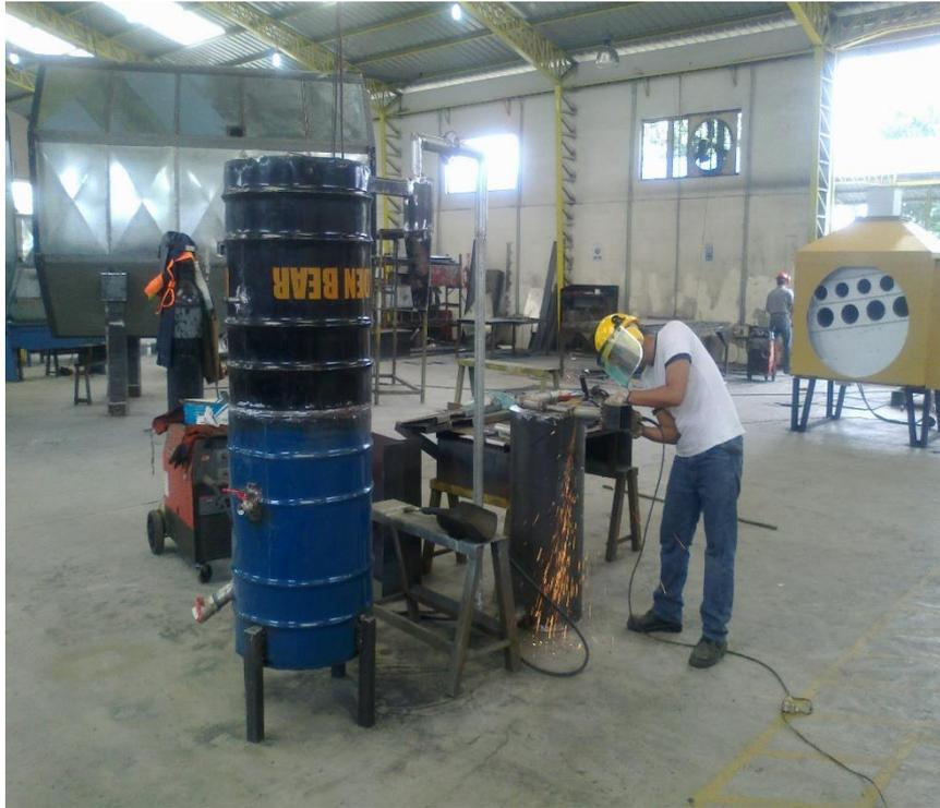
**Ultimando detalles de pulida del sistema de gasificación**
