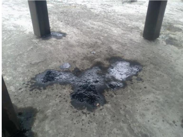
**Figura 16. Alquitranes y aceites condensados de la parte inferior del gasificador**
