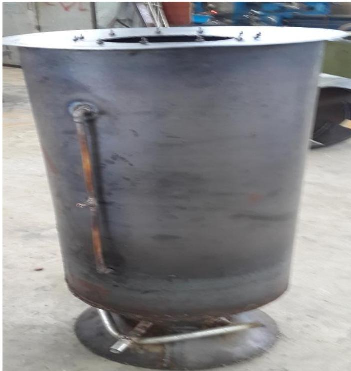
**Ensamblaje de las tuberías de gas y tapas del gasificador.**
