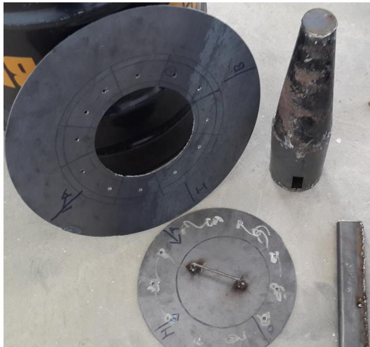
**Ciclón, tubería y tapas del gasificador**
