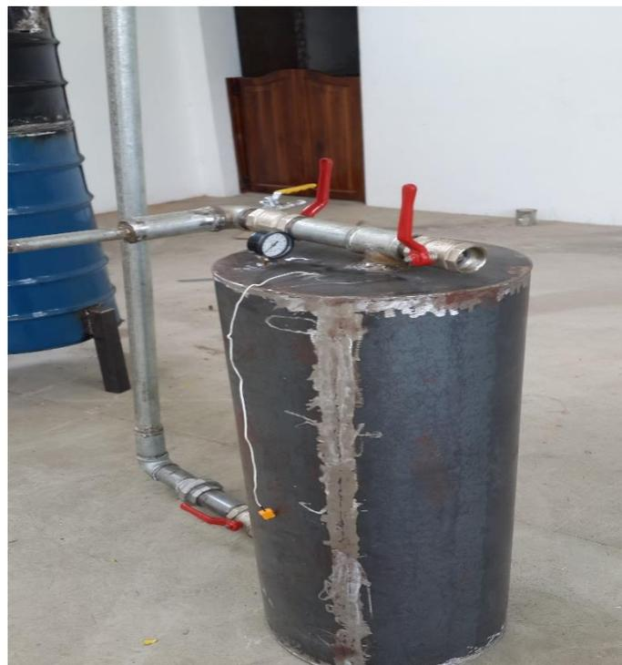
**Tanque de almacenamiento del gas, con su respectivo quemador.**
