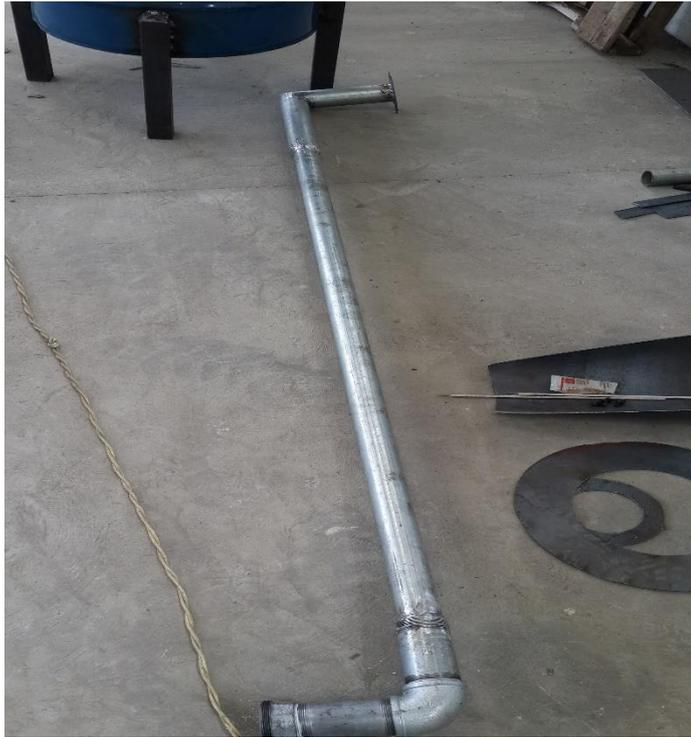
**Tubería que conecta al ciclón con el tanque de lavado del gas.**
