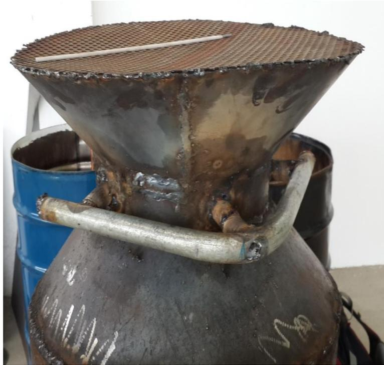
**Colocación de la entrada de aire en la garganta.**
