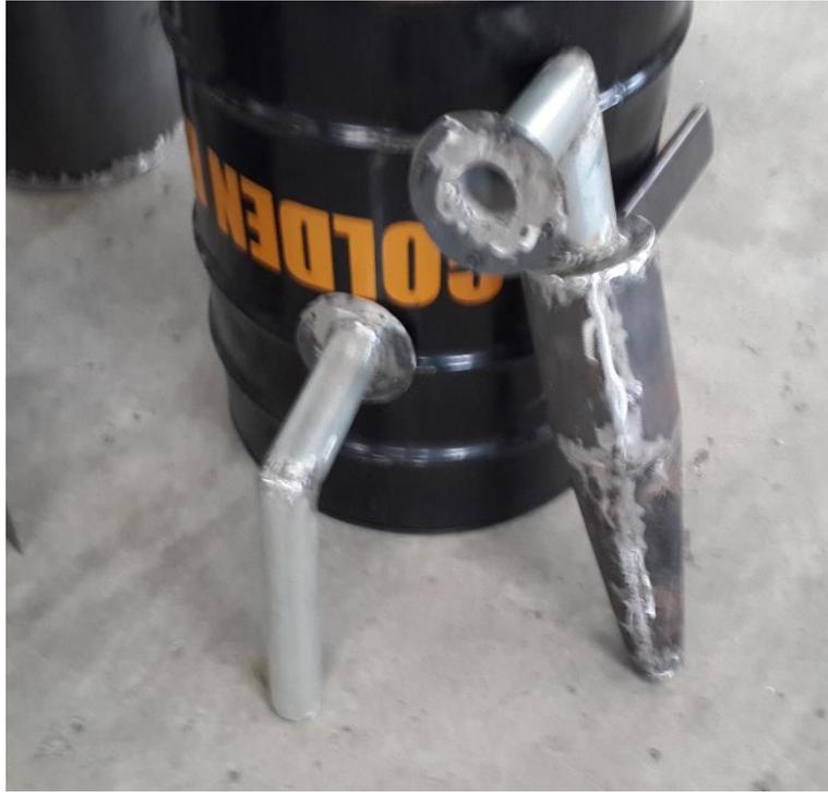
**Ciclón con sus respectivas tuberías de entrada y salida**
