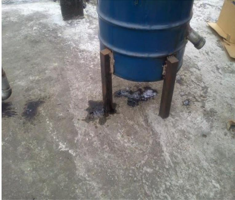
**Aceites y alquitranes condensados debido a fugas del gas #1**
