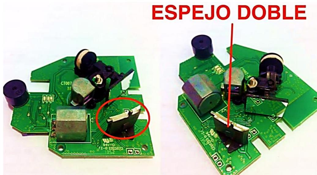
**Figura 16.** Espejo doble del escáner tipo pistola. Información tomada de: (Jurado, 2015), elaborado por el autor.
