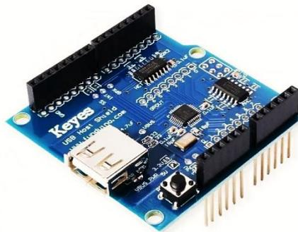
*Figura 60. Arduino Shield USB host. Información tomada de: (techmake, 2019), elaborado por el autor.*
