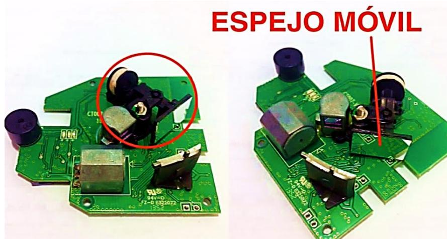
**Figura 17.** Espejo móvil del escáner tipo pistola. Información tomada de: (Jurado, 2015), elaborado por el autor.
