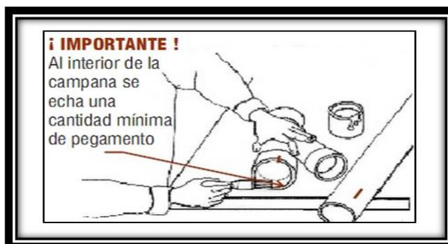
Ilustración 12: Aplicación de pegamento a los accesorios
