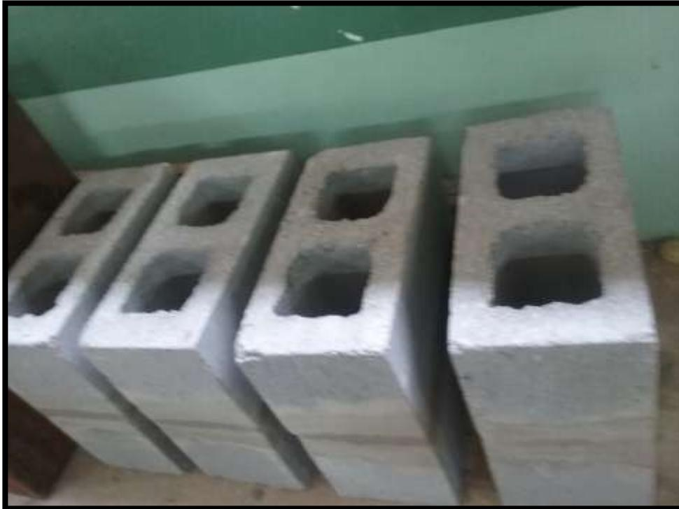
Figura 18. Prismas de 2 unidades para ensayo a la compresión sin relleno.
