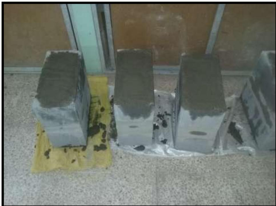
Figura 19. Prismas de 2 unidades para ensayo a la compresión rellenos de grout.
