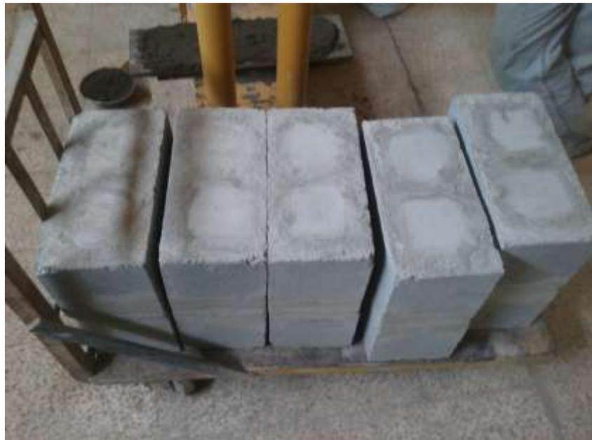
Muestras de pilas de 2 bloques rellenas con mortero
