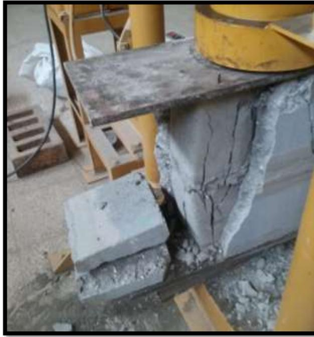
*Figura 20. Muestra de prismas ensayados.*
