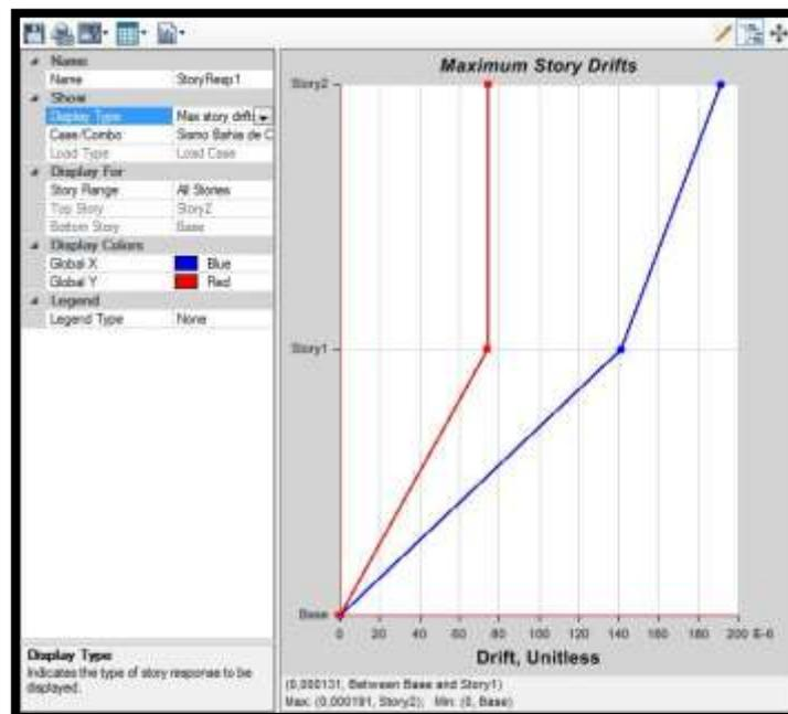
Figura 64. Gráfica de máximas derivas en ambas direcciones de la tercera estructura montada en suelo tipo D en Bahía de Caráquez.
