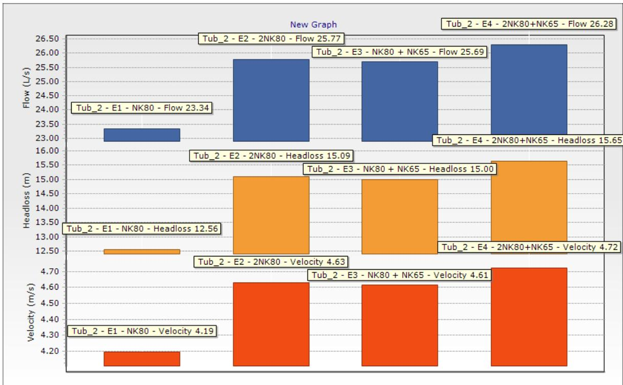
**Ilustración 26:** Resultados obtenidos en tubería 90mm
