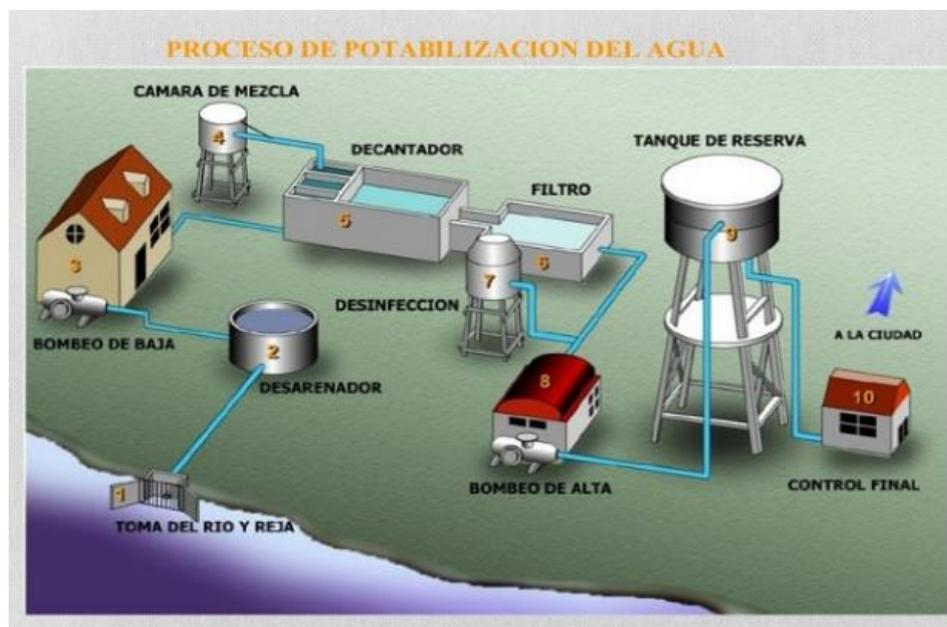
**Ilustración 5:** Proceso de potabilización de agua tipo convencional
