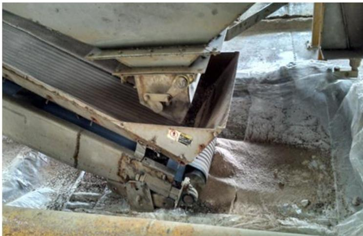
**Figura 18.** *Materia Prima Desperdiciada Por Banda Transportadora 1. Información tomada mediante investigación directa. Elaborado por el autor.*
