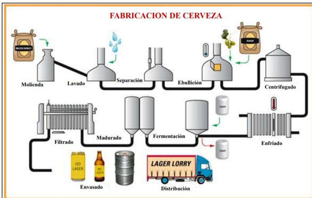
Ilustración 6. Proceso de la fabricación de cerveza
