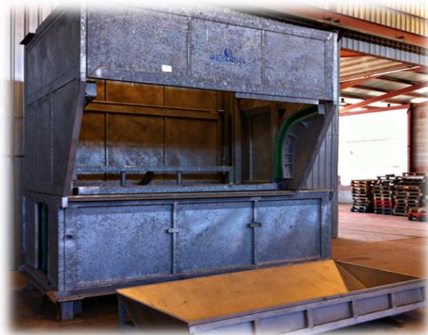
Ilustración 9. Sistema Ascensor Aturcido por CO2
