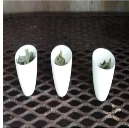
2. Determinación de humedad método gravimétrico
