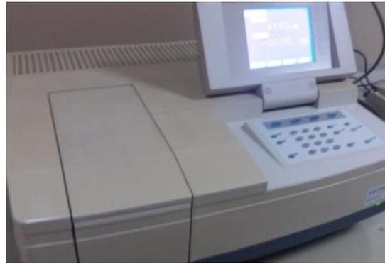
20. Espectrofotómetro usado para la determinación de flavonoides
