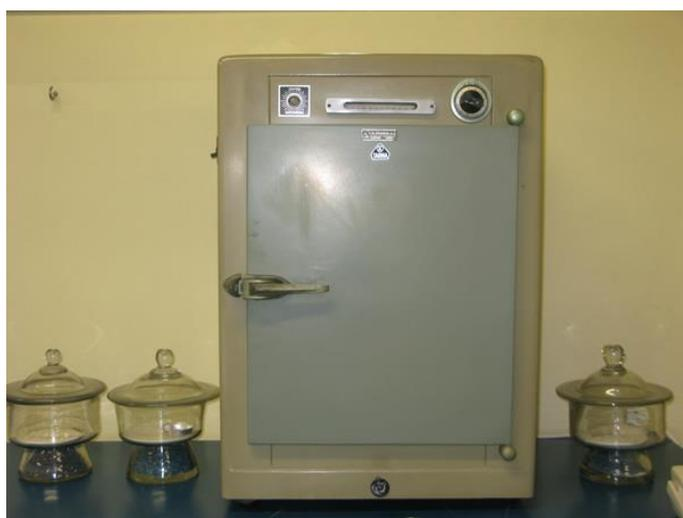
**Figura 3:** Determinación de Humedad por el Método gravimétrico de estufa.
