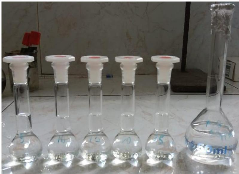
21. Soluciones de Ácido Gálico para la curva de calibrado
