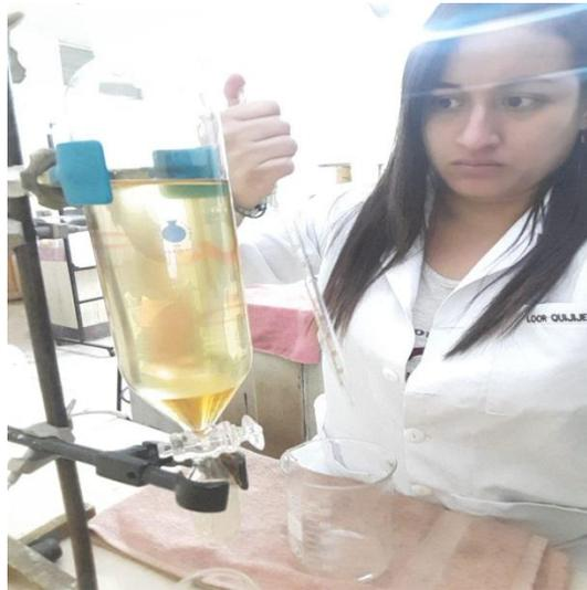
**Ilustración 14** Extracción del biodiesel obtenido
