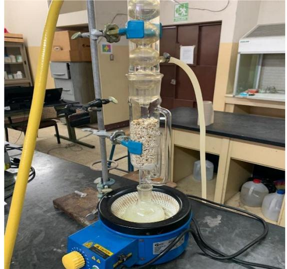
**Ilustración 4** Colocación de la muestra y del solvente dentro del equipo
