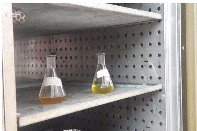
**Ilustración 8** Secado para la eliminación del exceso del hexano
