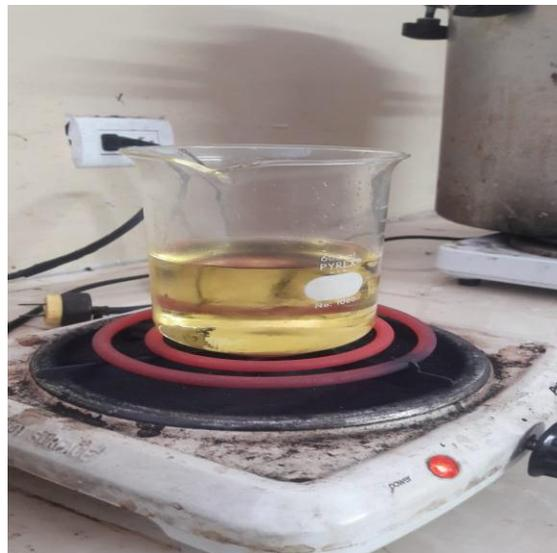
**Ilustración 17** Secado del biodiesel
