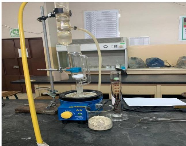
**Ilustración 3.** Montaje del equipo de soxhlet
