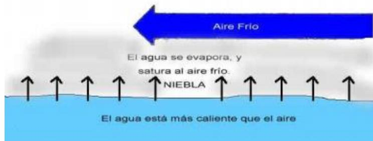
**Figura 2** Esquema de evaporación por aire frío
