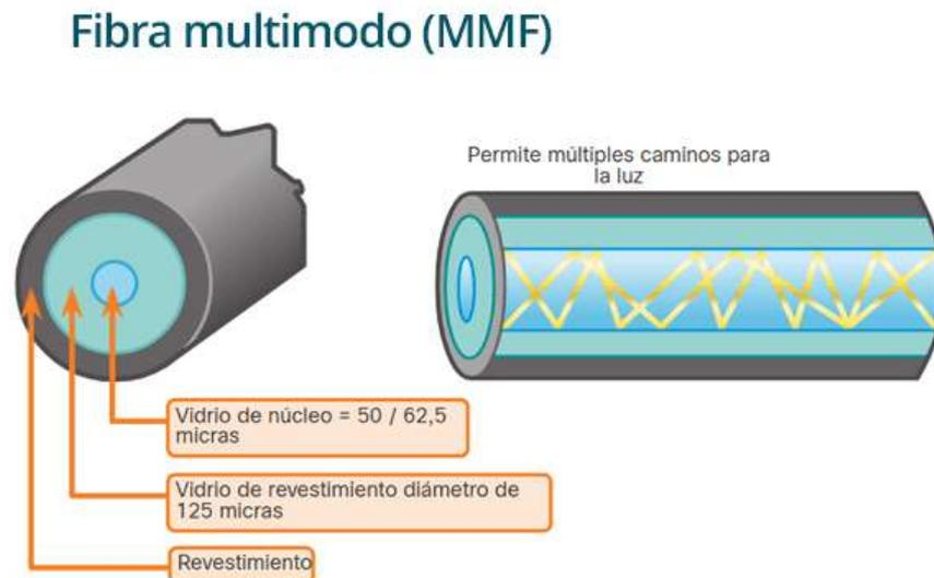
**Figura 11.** Esquema de fibra multimodo. Fuente: (CCNA, 2023)
