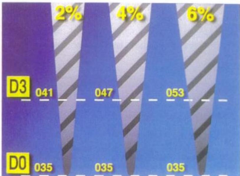
Fig.8. Instrumento con varias Conicidades, Cortesía Folleto de Densply
