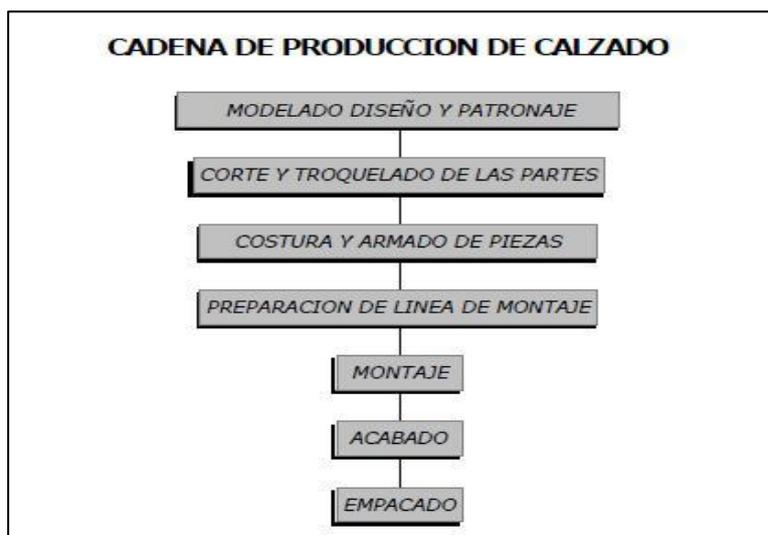
*Figura 1* Esquema de producción de calzado. Tomado del Proyecto de CORPEI-CIB-2001
