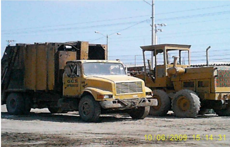
Camión recolector y pala mecánica
