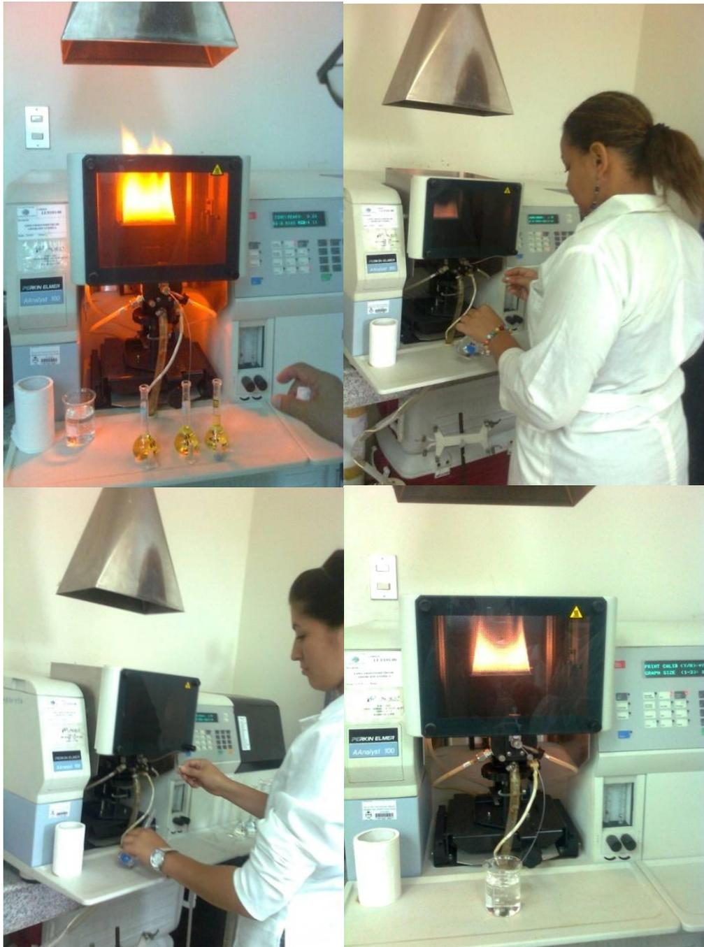
**Fig. 44.- Lectura de Agua, Sedimento y Organismos en el Espectrofotómetro de Absorción Atómica**
