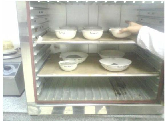
**Fig. 34.- Secado en la estufa**
