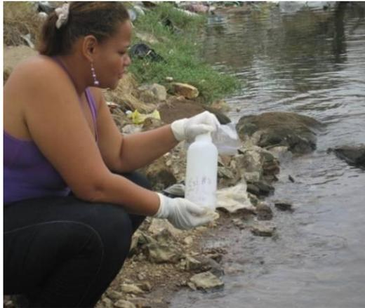
**Fig. 20.- Toma de muestra de agua descargas al Estero**
