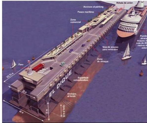
*Ilustración 2-24 - Esquema del Sistema utilizado en el Puerto de Montecarlo
