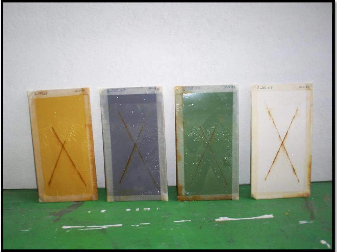
**Anexo 4. Resultados de Pruebas de salinidad para verificar resistencia a la corrosión. (Ver muestra de Anticorrosivo Negro desarrollado con material reciclado) frente al Anticorrosivo Negro Professional.**
