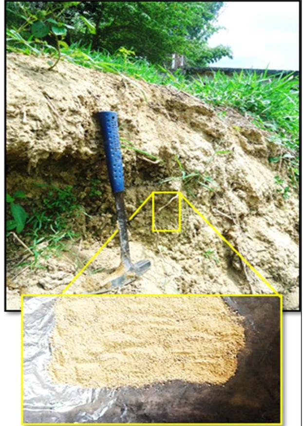
**Figura 3.** Arena arcillosa de color marrón amarillento pálido, el tamaño de grano de la arena va de medio a grueso con presencia de arcillas que se encuentran a 1m sobre el nivel del mar.
