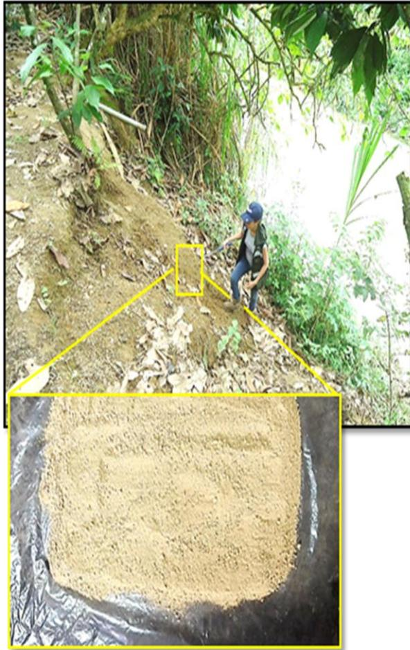
**Figura 1.** Terraza aluvial de arena arcillosa no compactada que se encuentran a 1 m sobre el nivel del mar, de color marrón amarillento moderado, el tamaño del grano es de medio subred ondeado a subangulo.
