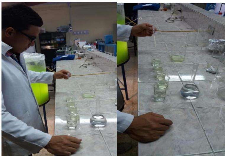
Ilustración 19. Floculación de microalgas con polielectrolito
