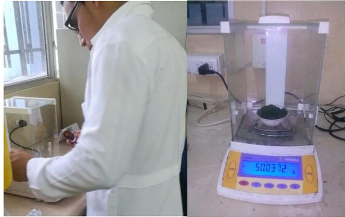
Ilustración 23 Medición de biomasa seca
