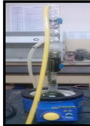
Figura 6 Sistema Soxhlet
