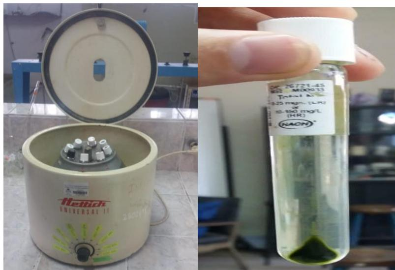
Ilustración 21 Representación de biomasa centrifugada
