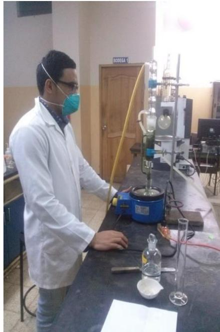
Ilustración 25. Extracción lipídica de microalga
