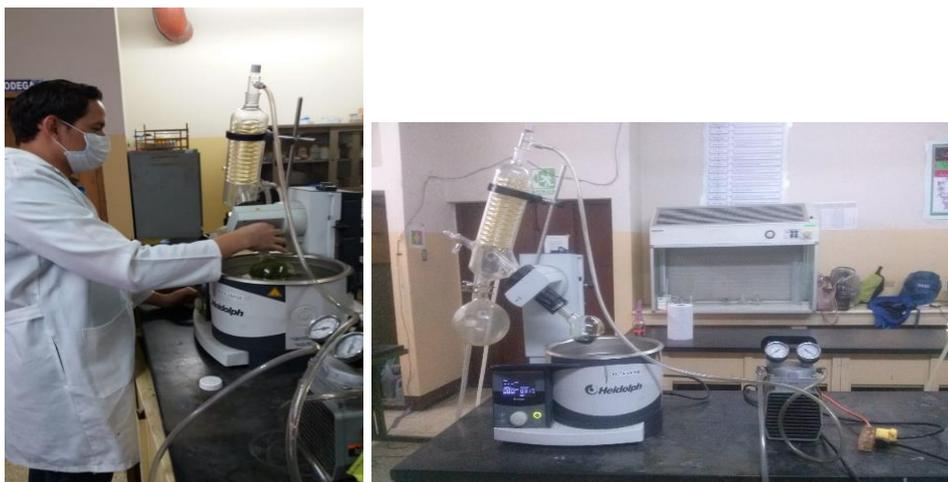
Ilustración 26. Procedimiento de separación de líquidos en el Rotavapor
