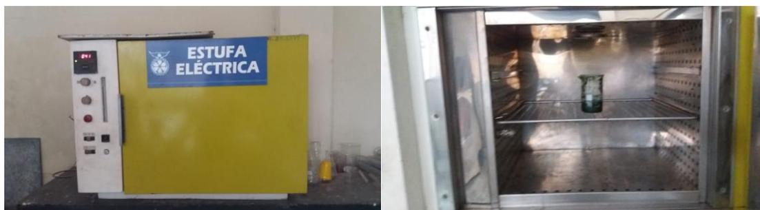
Ilustración 22 Biomasa a 60°C en la estufa eléctrica
