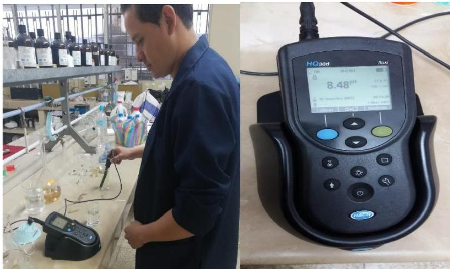
Ilustración 17 Medición de pH
