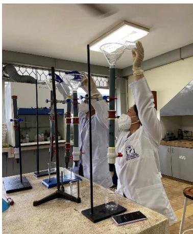
*Ilustración 10. Lavado de muestreadores con solución KCl para sulfatos.*
