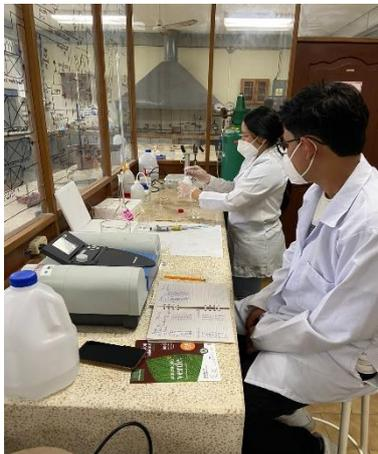
*Ilustración 12. Incorporación del reactivo acondicionador y cloruro de bario a las muestras de sulfato.*
