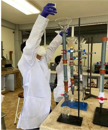
*Ilustración 11. Lavado de muestreadores con agua destilada para nitratos.*
