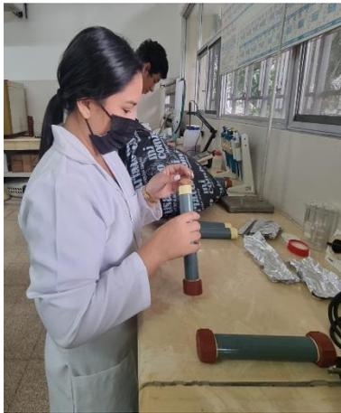
*Ilustración 3. Colocación de lana de vidrio en los muestreadores.*
