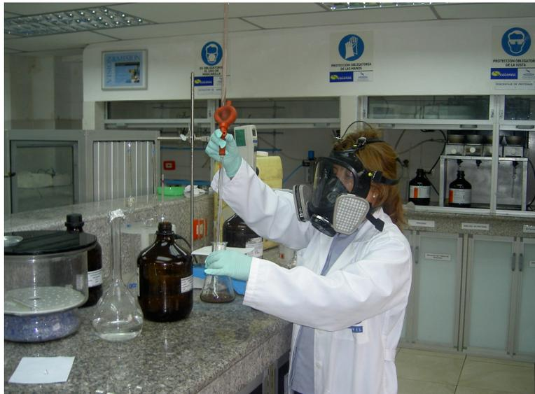
Fig. 7 Determinación I.Iodo (Wijs) AOCS Cd-01-25
