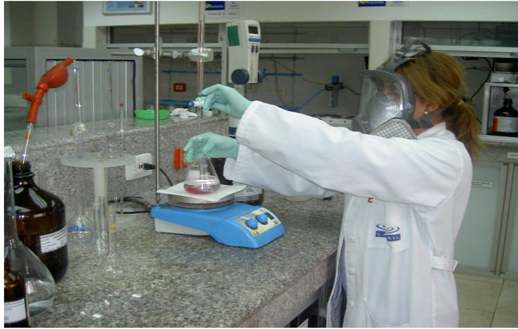
Fig. 8 Determinación I.Iodo (Wijs) AOCS Cd-01-25
