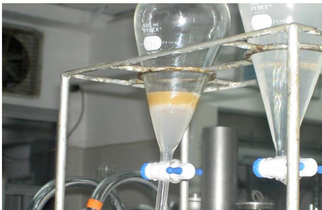
Fig- 13 12 Hidroxiestearato de etilo, proceso de lavado
