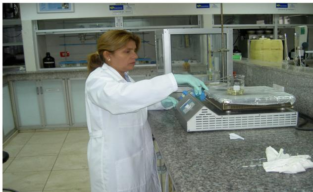
Fig. 4 % Humedad , AOCS Método Hot Plate Ca-2b-38
