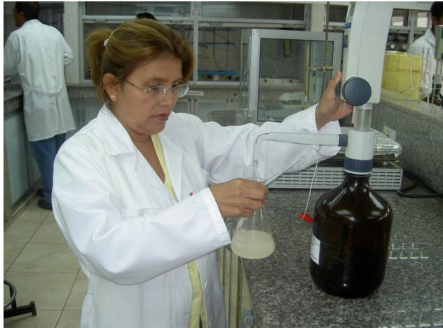
Fig. 2 Anàlisis de acidèz %FFA , método AOCS Ca-5<sup>a</sup>-40
