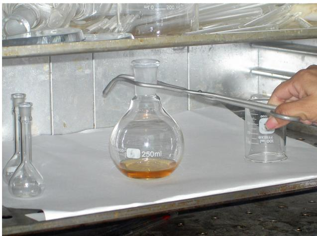
Fig. 18 Hidroxiestearato de etilo, secado en estufa
