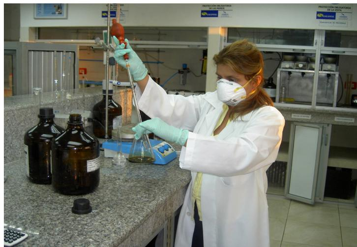
Fig. 9 Determinación I.Iodo (Wijs) AOCS Cd-01-25
